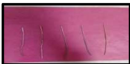
**Gambar 1.** Hasil Pengujian *Reinsch Test* pada Sampel
